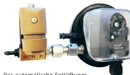
Das automatische Entlüftungssystem besteht aus einem Differenzdruckwächter mit einem zusätzlichen 2/3-Wege-Ventil. Mit Hilfe dieses Bauteils lässt sich der Luftstrom der Abluftanlage kurzzeitig unterbrechen, um eine automatische Prüfung der Sicherheitskette durchzuführen.
